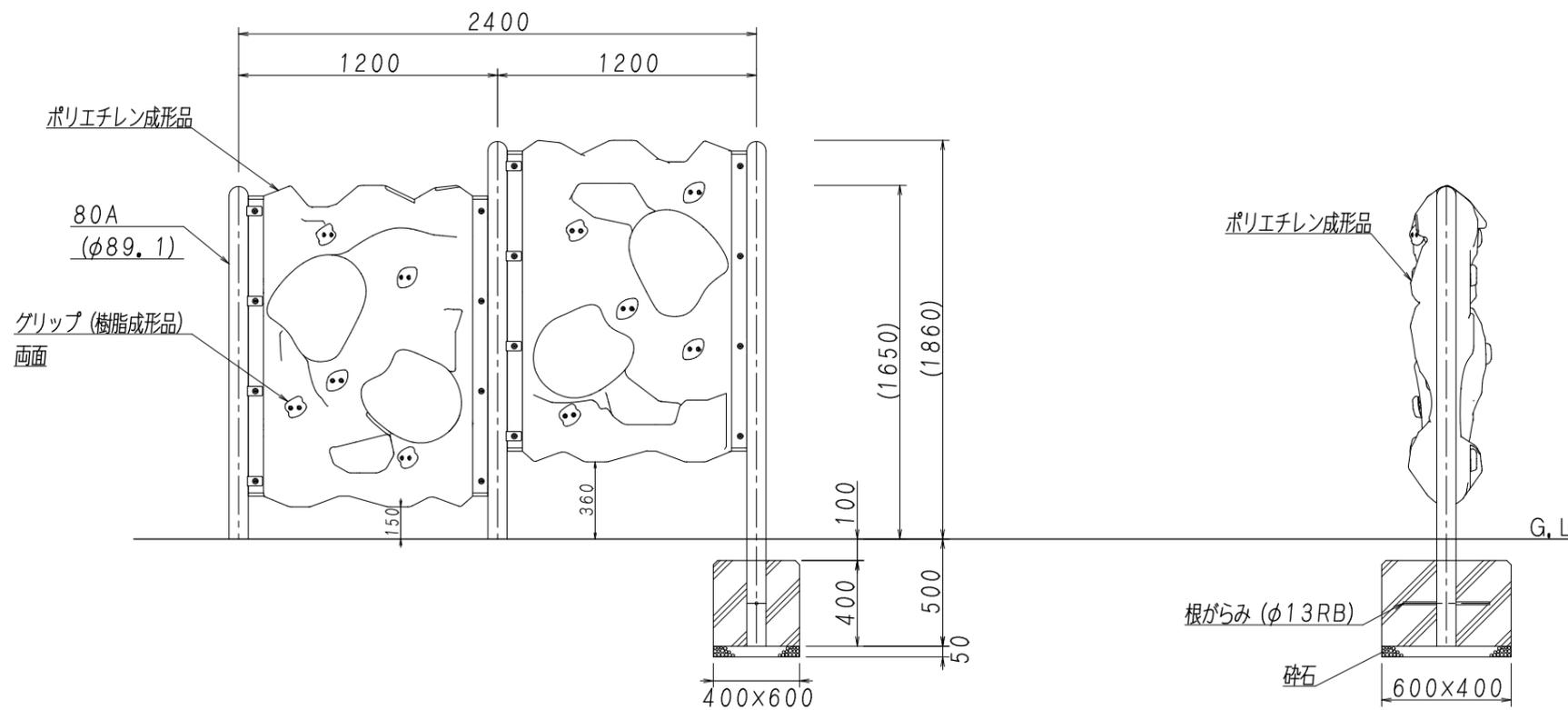
鋼材・鋼管は、電気亜鉛メッキ下地のうえ、アクリル焼付塗装仕上とする
